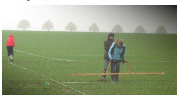
*Vermessung im Feld, hier: geoelektrische Untersuchung eines neolithischen Erdwerkes mit selbstgebastelten Messapparaturen*
