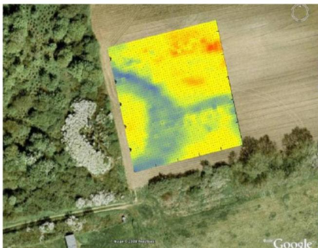
*Geoelektrische Vermessung an der Hüneburg, 50m x50m niedrige Widerstände blau, S. Grottke / T. Hein 2008/2009: Man erkennt die mittelalterliche Grabenanlage der Motte mit Zufluss sowie möglicherweise Siedlungsstrukturen einer Vorburg (rechts oben).*
